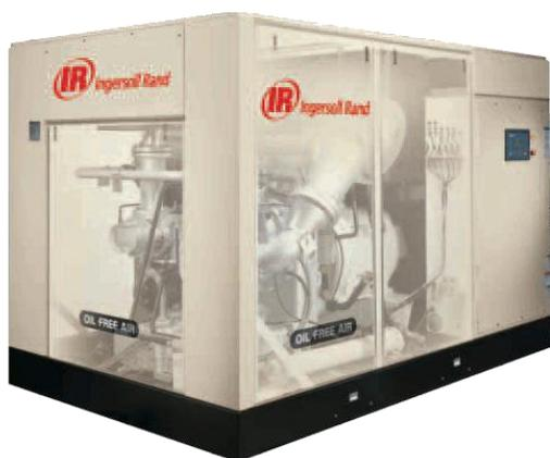
El aire comprimido entra después en la segunda etapa para ser comprimido hasta un valor de presión de descarga ligeramente mayor a la nominal del compresor, posteriormente es enfriado en el refrigerador final hasta la temperatura de descarga final de diseño. La condensación que nuevamente aparezca es retenida en el separador de humedad y se descarga a través de las electroválvulas de drenaje automático.
