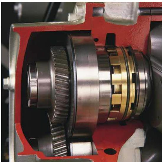
Engranajes de Sincronización de máxima calidad para mantener al mínimo las holguras de rotación garantizando al tiempo el máximo rendimiento volumétrico del compresor. Tanto éstos como los engranajes de transmisión de potencia son engranajes calidad AGMA 12.
